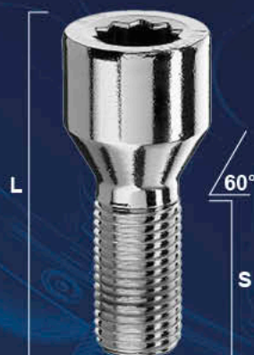
Болты под внутренний многогранник, M14x1,5, конус, внешний диаметр 23 мм
