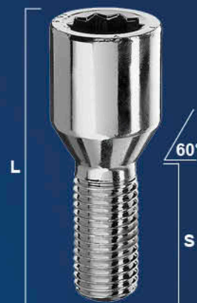
Болты под внутренний многогранник, M12x1,75, конус, внешний диаметр 20 мм
