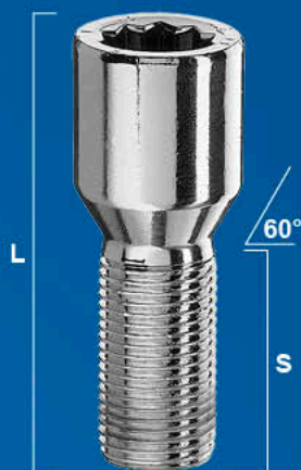
Болты под внутренний многогранник, M14x1,25, конус, внешний диаметр 20 мм
