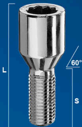
Болты под внутренний многогранник, M12x1,5, конус, внешний диаметр 20 мм
