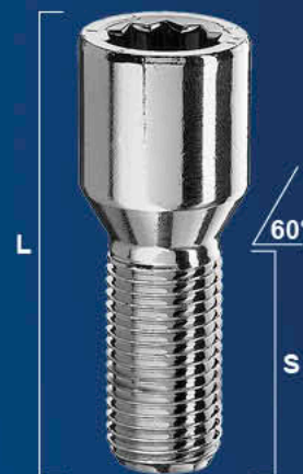
Болты под внутренний многогранник, M14x1,5, конус, внешний диаметр 20 мм
